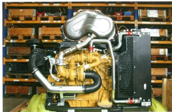
Antriebseinheit von CAT für Syncrofalke-Anhänger gemäß Tier 4 final: Das AdBlue-System sitzt über dem Motor Fotos: Matzer (3)
