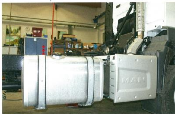
Zwischen Dieseltank und Vorderachse ist bei MAN der Euro 6- Schalldämpfer mit integriertem Rußfilter verbaut
